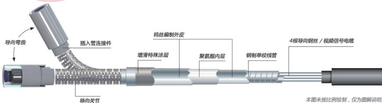
美泰电子视频内窥镜采用间接目视检测原理，利用探头顶端的CMOS图像传感器实时采集狭小空间内表面的图片信息并通过插入管内的视频信号电缆将数字信号传输至仪器主机从而实现图像的显示和存储，装有图像传感器的探头通过导向关节与插入管连接，导向关节可通过内置的导向钢丝在手动控制下四个方向转动方便图片传感器实时拍摄传输图片资料。
